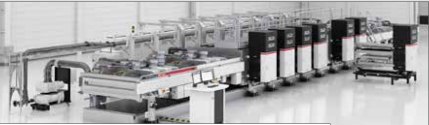
CÁC HỆ THỐNG PHỦ THEO CHIỀU NGANG VỚI SẢN LƯỢNG LỚN
